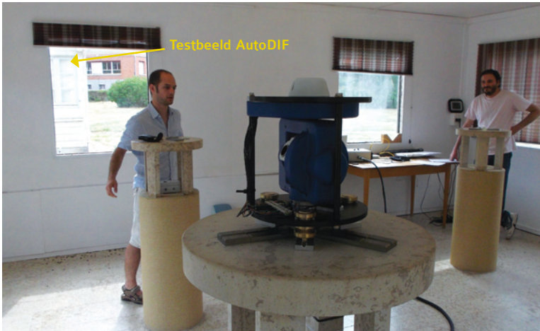
▲ Afbeelding 3: AutoDIF op zijn zuil voor absolute metingen.
